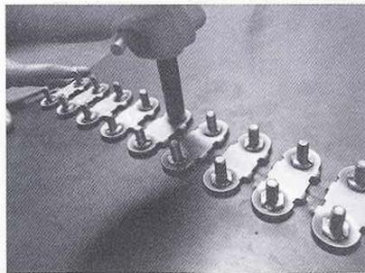
2. ナット側が表にくるように、ベルトにファスナーをセットし、専用工具のレンチを使用し、均等にナットを締めます。
