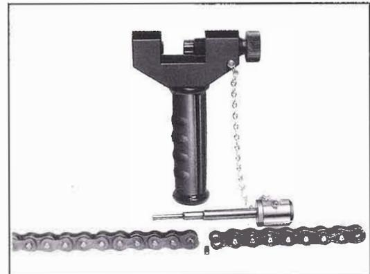
④ ピンが飛び出してからストレートパンチを引きぬき固定ネジをゆるめて下さい。
