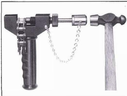
③ ストレートパンチを 数回かるく打って下さい。それから固定ネジを再び締めつけて下さい。そしてピンが写真のように飛び出すまで連打して下さい。
